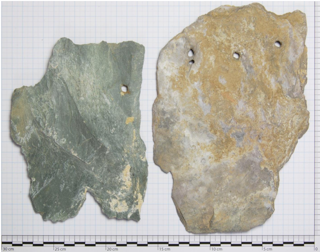
Omschrijving: Dakleien met spijkergaten (fotograaf R. Snijders, 20-03-2013)
